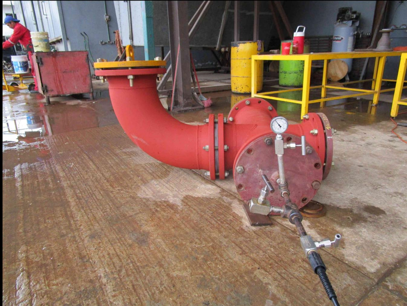
**PRUEBAS HIDROSTATICAS A PIEZAS ROTOMOLDEADAS PREVIO A SU INSTALACION**
